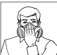
Contrôle de l'étanchéité au visage par pression positive: placer la paume de la main sur la soupape expiratoire et expirer doucement. Si le masque assure une bonne étanchéité, aucun filet d'air ne doit s'échapper entre le masque et le visage. Ajuster le masque et répéter l'opération si nécessaire.
