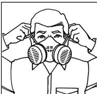
Régler la tension des brides. Contrôler que l'étanchéité entre le visage et le masque est bien réalisée avant de rentrer dans la zone d'exposition.
