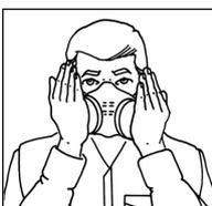
Contrôle de l'étanchéité au visage par pression négative: placer les paumes de main sur les filtres anti-gaz et inspirer doucement. Si le masque est étanche, la pièce faciale va subir une légère contraction aspirant le visage. Ajuster le masque et réitérer la procédure si nécessaire.
